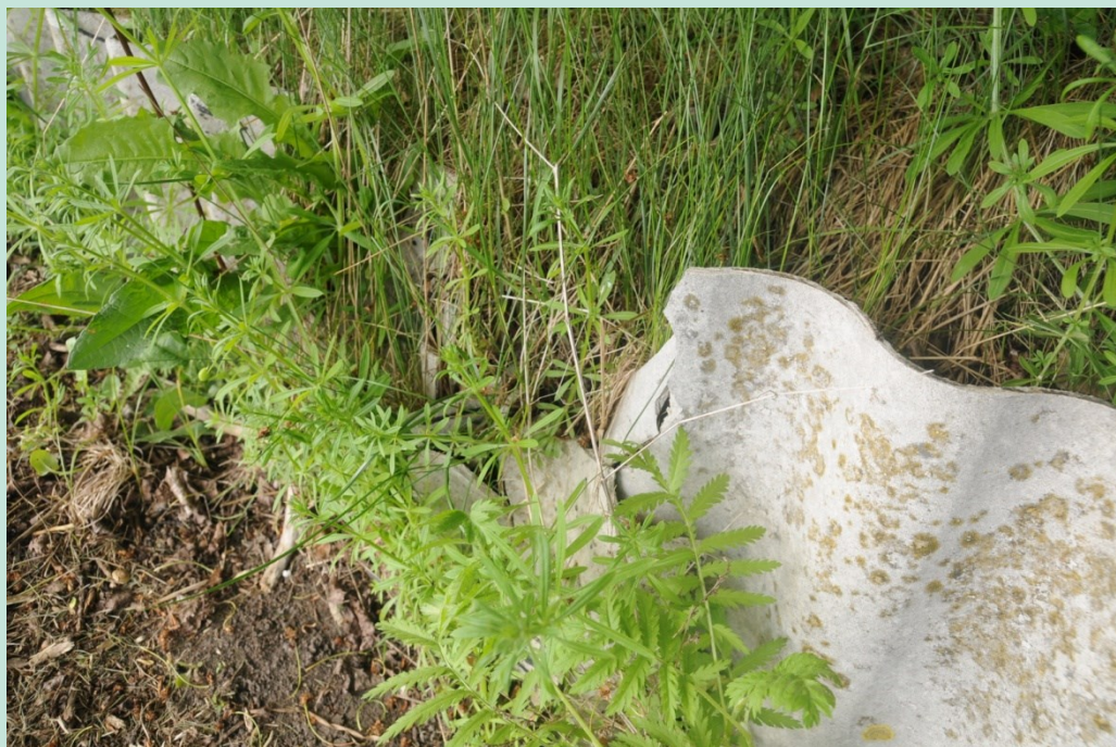
BILLEDE 4 NÆRBILLEDE AF KNÆKKET ETERNITPLADE FRA SAMME STED SOM BILLEDE 3
