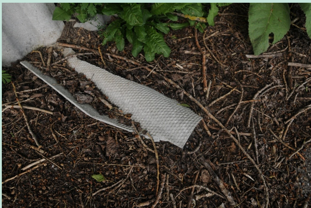
BILLEDE 5 NÆRBILLEDE AF KNÆKKET ETERNITPLADE FRA SAMME STED SOM BILLEDE 3
