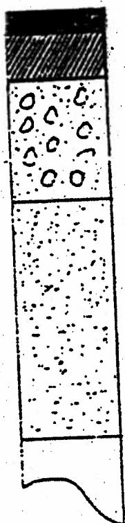
2-3 cm pulverasfalt eller asfaltbetonslidlag.
