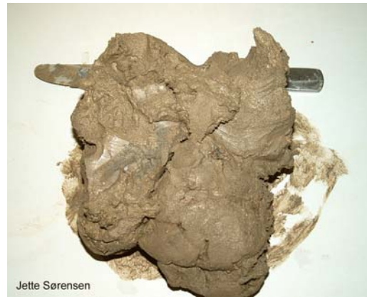
Figur 1.3b. Prøve løsboret med vingemejsel i lufthæveboring.
