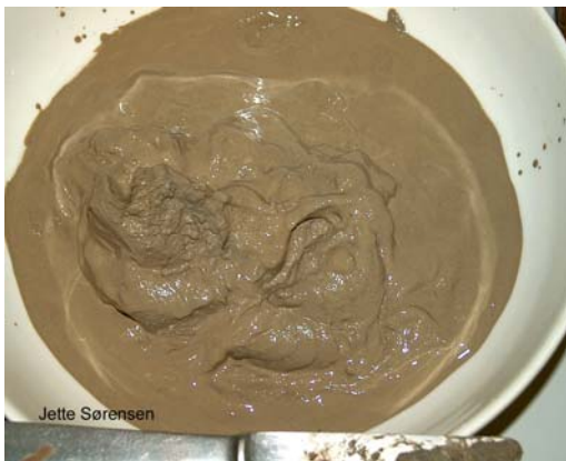
Figur 1.3c. Prøve løsboret med rullemejsel i lufthæveboring.
