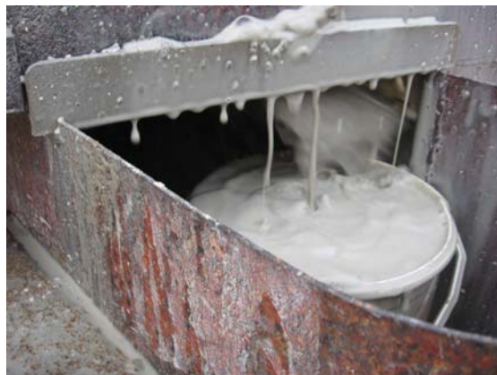
Figur 2.5b. Opsamling af prøve i sedimentfang med tragt.
