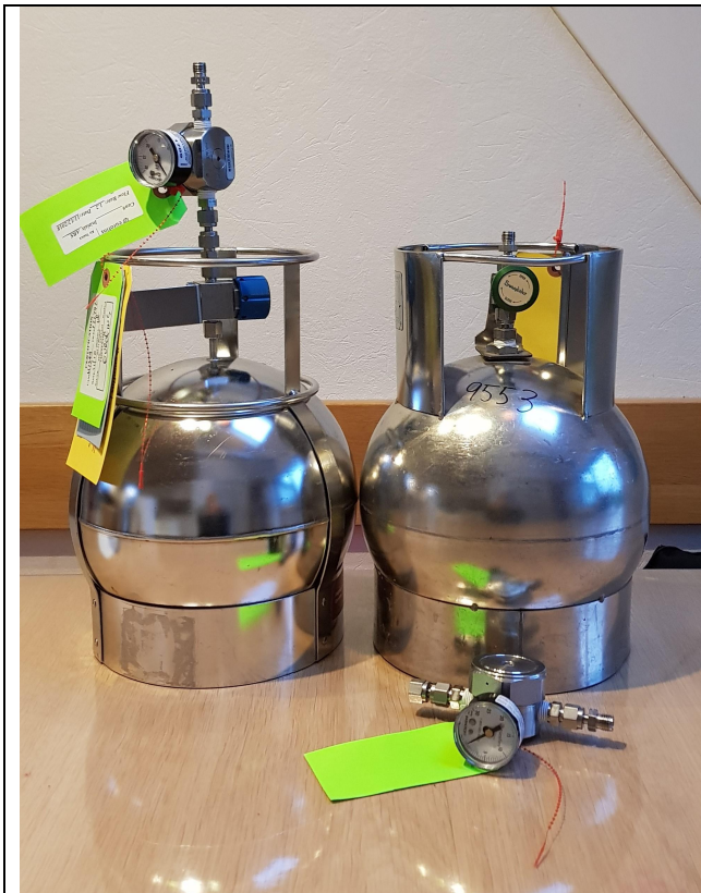
Foto 4.1: Canister med og uden flow controller. Manillamærker til udfyldelse, se afsnit 5.4
