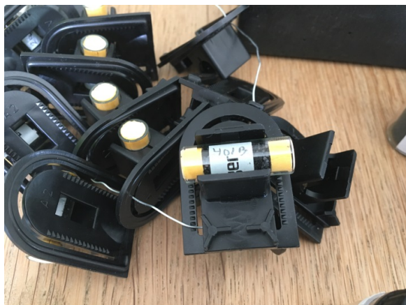
ORSA-rør i ophængs-klemme.
